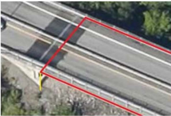
Figur 2. Eksempel på registrering av spennvidde (i luft).
