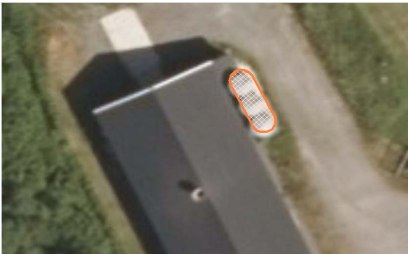
Figur 19. Når det er flere tanker ved siden av hverandre skal de registreres som et sammenhengende polygon, dersom det samlede arealet overstiger minstemål. Underste bilde viser tre tanker (hver enkelte Tank under minstemål) som skal registreres sammenhengende ettersom det samlede arealet overstiger minstemål.
